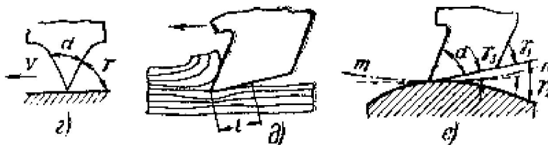
Рис.13. Влияние элементов зуба пилы и способов пиления на величину сопротивления резанию
